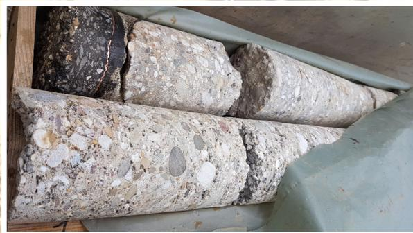
Im Sommer wurden Bohrungen und Rammsondierungen im Bereich der alten Lahnbrücke von der Fa. Handke vorgenommen. Im oberen Bohrkern kann man gut die dunkle Asphaltdecke, darunter einen Teil des metallischen Blitzschutzes erkennen, bevor die Betonbewehrung beginnt. Der Beginn der Bauarbeiten für die neue Lahnbrücke erfolgt voraussichtlich im zweiten Halbjahr 2019.
